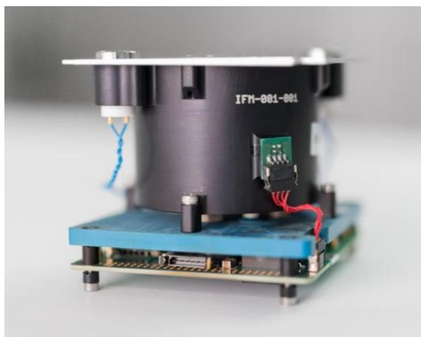
Fig. 1. Das integrierte Antriebssystem, der IFM Nano Thruster von FOTEC
