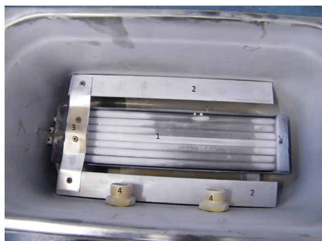
Abb.1 Prozesskammer von innen: 1) Heizelement; 2) Substrat-Auflagefläche; 3) Thermoelement; 4) Gasauslässe
