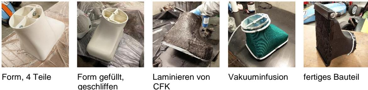
Abb.5: Verfahrensschritte Lüfter-Gehäuse
