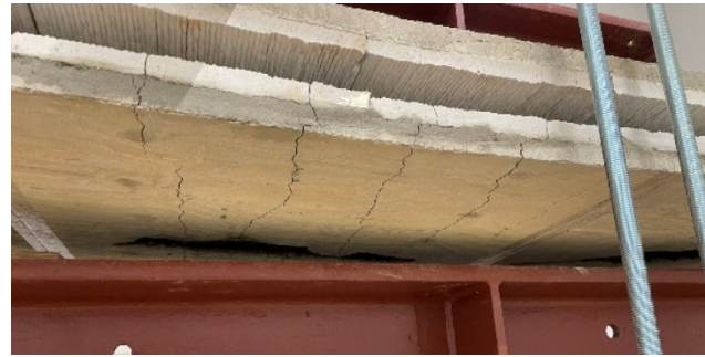
Abbildung 6: a) Vergleich der Prüflast und der errechneten Last im Kraft-Verformungsdiagramm und b) Biegerisse im Demonstratorbauteil zwischen den Lasteinleitungspunkten
