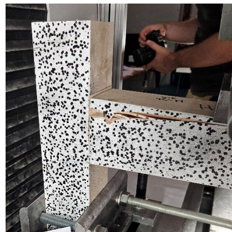
Abbildung 5 Kraft-Maschinenweg Sherpa S-10 (links); Versagensbild (rechts)
