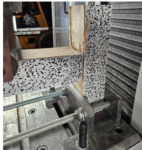
Abbildung 4 Kraft-Maschinenweg Balkenschuhe (links); Versagensbild (rechts)
