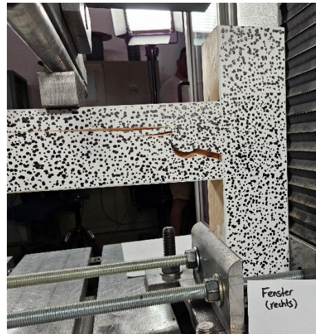
Abbildung 6 Kraft-Maschinenweg Holz-Holz Prototyp (links); Versagensbild (rechts)
